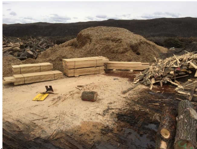
Figure 8: Lots de planches issus d'une opération de sciage. Les croûtes sont visibles à droite: ce sont les retailles des billes comprenant l'écorce. Elles seront déchiquetées pour neutraliser les larves d'agrile. © Scierie Clément Gagnon
