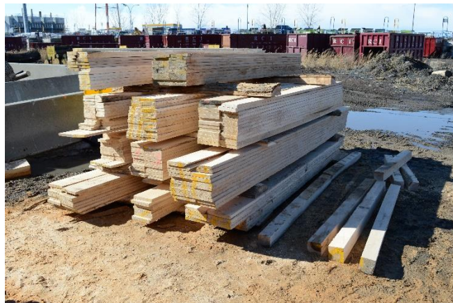
Figure 6: Les planches fraîchement sciées sont prêtes à être emportées au séchoir. © CQEEE
